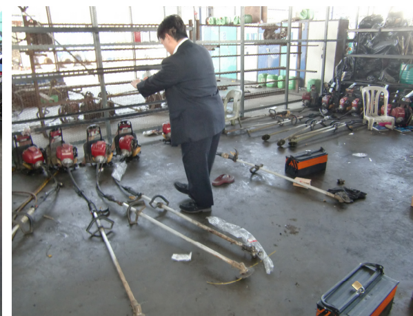
芝刈り機。1日10～12台持ち込まれる。オイル交換・修理を行う。
