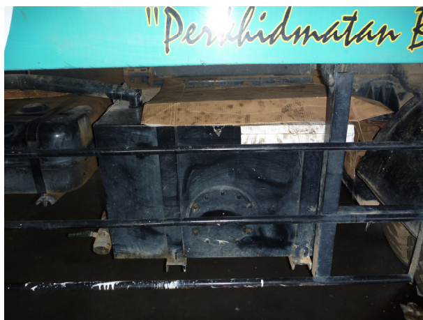
汚水タンク。ごみの水をためてランドフィルで出す。
