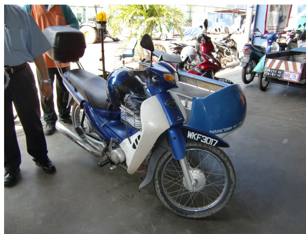
サイドバイク。取りこぼしのごみ収集や狭い道での回収に使用される。
